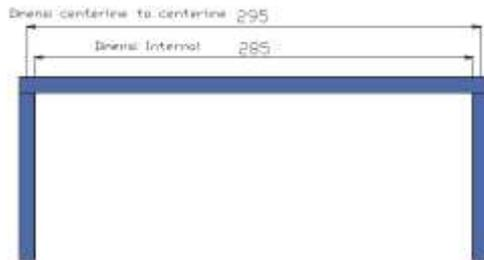
**Gambar 9.** Dimensi *Centerline to Centerline* Rak
